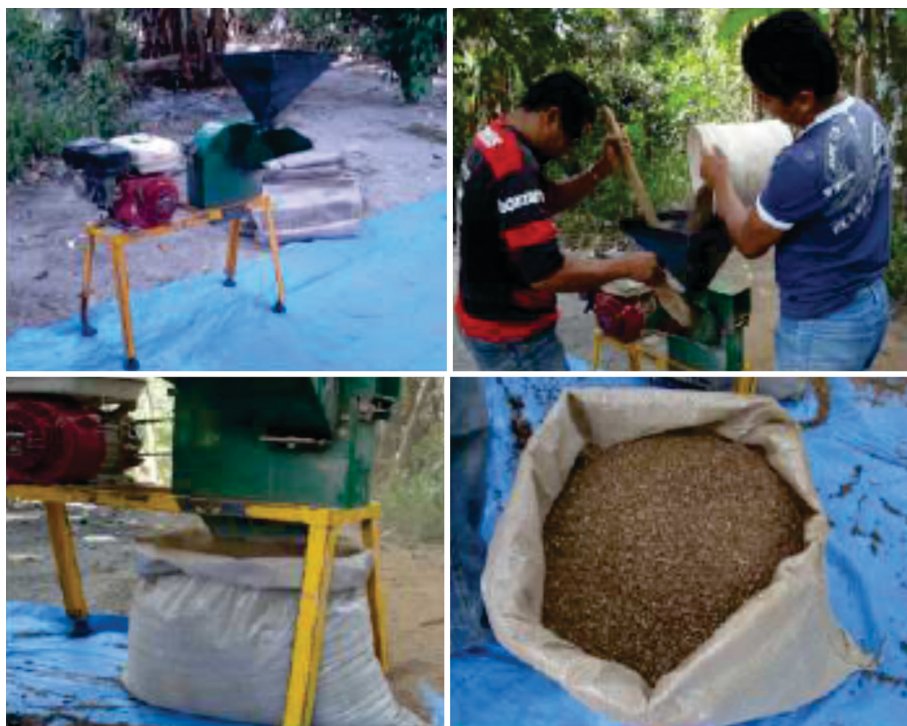
Figura 3 – Processo mecanizado de separação do carrapicho
