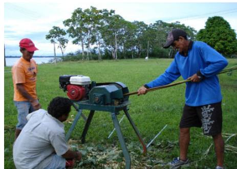
Figura 3 – Protótipo da máquina descortadora Arraia em teste experimental
