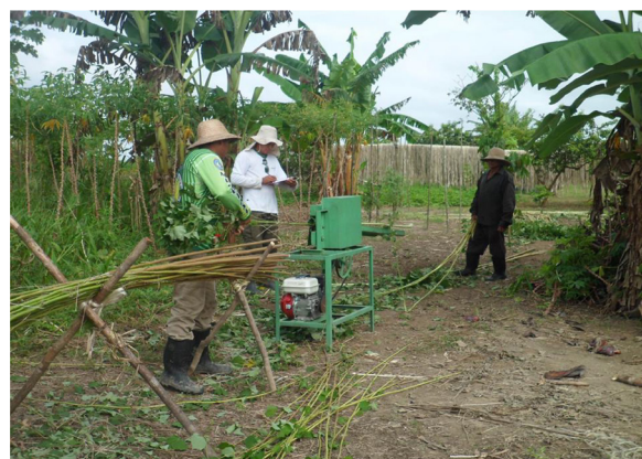
Figura 6 – Teste em campo da versão de 2014 da máquina descortecedora. Apenas as fitas são imersas
