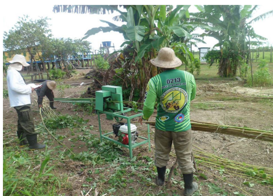
Figura 6 – Teste em campo da versão de 2014 da máquina descortecedora. Apenas as fitas são imersas
