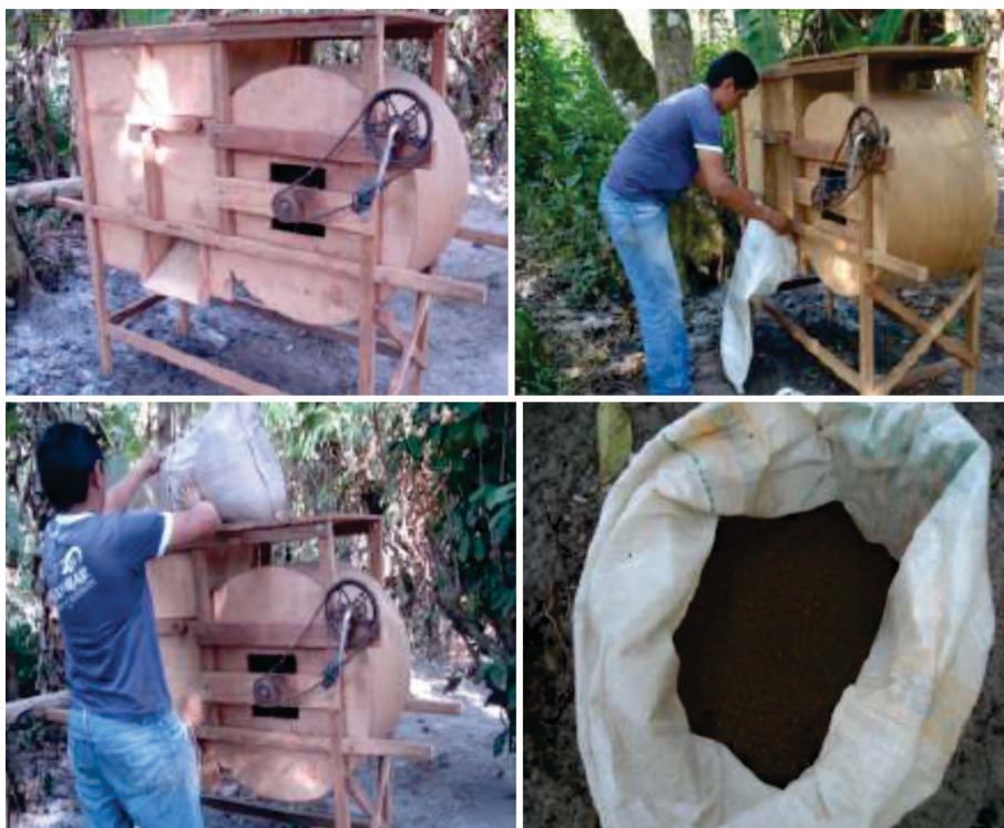
Figura 4 – Máquina para ventilar e retirar as impurezas das sementes
