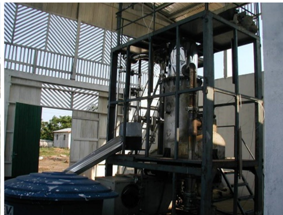
Foto 4 – Sistema de gaseificação para geração de eletricidade instalado em Aquidabam, município de Manacapuru, Amazonas
