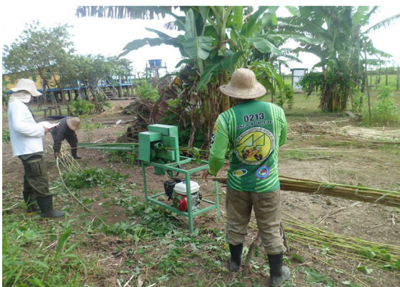
Figura 6 – Teste em campo da versão de 2014 da máquina descortadora. Apenas as fitas são imersas
