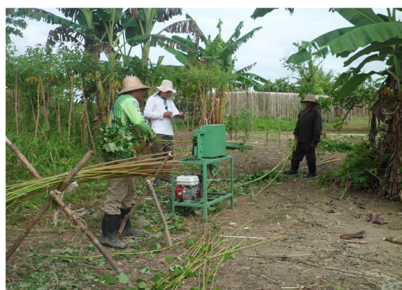
Figura 6 – Teste em campo da versão de 2014 da máquina descortadora. Apenas as fitas são imersas
