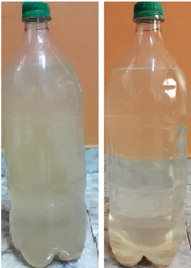
Figura 5 – Garrafas de água do rio Javari antes e após o tratamento com Moringa oleífera
